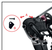
10 Jemně našroubujte trojúhelníkový kryt, pomocí T7 torx klíče (nepřetahujte, hrozí prasknutí) PS. A: Vymeovací šroub B: Zarážka (stopper)
