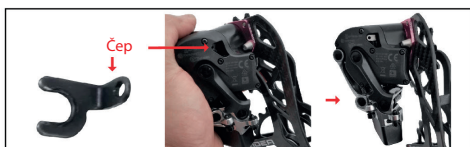
9 Vsuňte čep. Držte přitom vodítko měniče.
