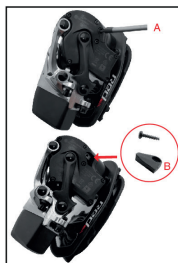
2 Použijte T7 torx klíč k odněti trjúhelníkového krytu měniče. PS. A: T7 Torx klíč B: Trojúhelníkový kryt
