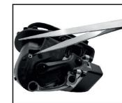
3 K vyjmutí čepu použijte pinzetu nebo podobný nástroj. Dávejte pozor, aby čep rychle nevyskočil.
