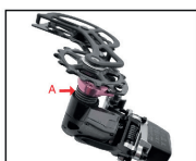
7 A: Nejprve připevněte OSPW+ vodítko do těla měniče. Netlačte až do konce a nechte si prostor pro otáčení.
